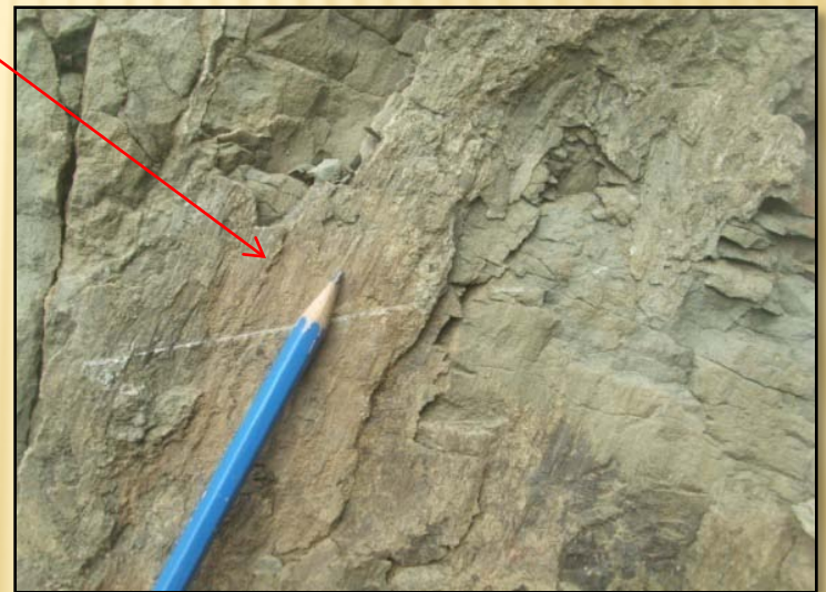
Kenampakan sesar Naik Ngetuk Right Reverse Slip Fault (Rickard, 1972. ) pada Formasi Kerek di Desa Ngetuk, Kecamatan Wonosegoro, Kabupaten Boyolali – Jawa Tengah
