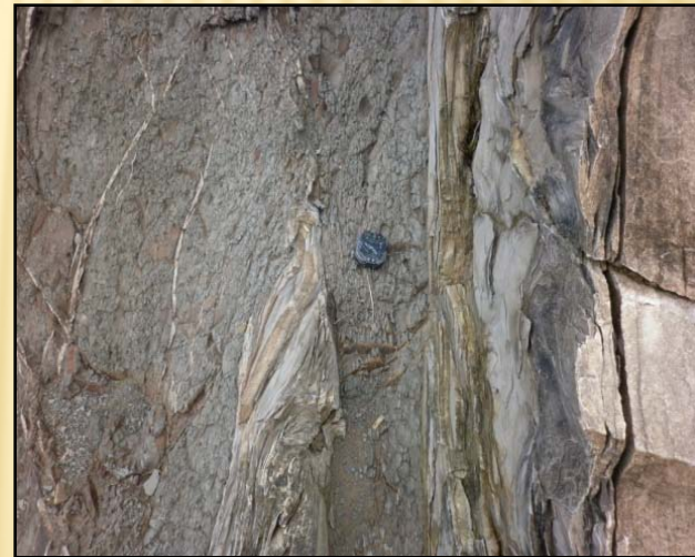
Kenampakan lapisan tegak dan zona sesar pada sesar Garangan Reverse Slip Fault (Rickard (1972))
